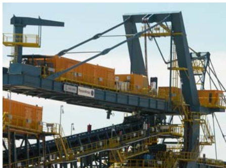
Slika 2. Strela protivtega odlagaca nakon montaže opreme i balasta
