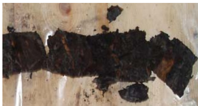
Slika 4: Karakterističan izgled barskog uglja sa prosljocima ksilita iz ležišta Ostružnja
