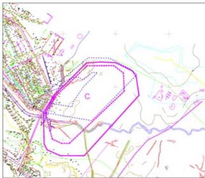
Slika 1. Uporedna analiza završnih kontura (Ljubičasta linija - kontura Polja C po Planu razvoja do 2020.; Plava isprekidana linija - kontura Polja C po projektu iz 2010.)
